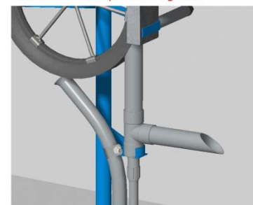
4. Het T-stuk, uitloop en afvoer kunnen er los op worden gezet
